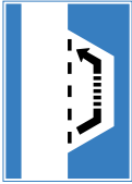
4.15 Place d'évitement (Pour véhicules lents afin de permettre le dépassement aux véhicules plus rapides. Arrêt volontaire et stationnement interdits)
