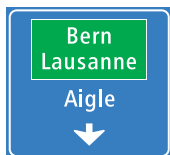
4.41 Panneau de présélection au-dessus d'une voie de circulation sur route principale
